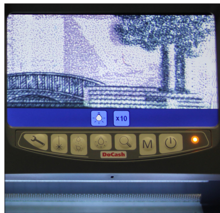
В случае активации функции увеличения изображения в 10 и 20 раз на экран выводится увеличенное изображение участка купюры, расположенного в зоне большого овала просмотрной панели
