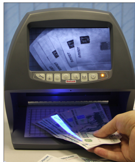
Проверка денег одновременно в двух режимах: на экран выводятся элементы изображения, нанесенные ИК-метамерными красками, а при взгляде на купюры становится заметна люминесценция отдельных участков банкнот, и отсутствие фоновое свечения бумаги у подлинных денег под воздействием ультрафиолета
