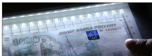
Включение коспадающего света позволяет выявлять OVI-краску
